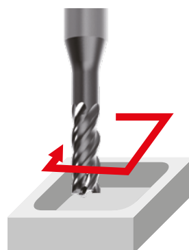
Frezowanie wgłębień (kieszeni)
